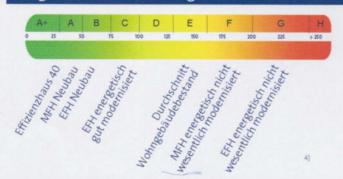
Die modellhaft ermittelten Vergleichswerte beziehen sich auf Gebäude, in denen die Wärme für Heizung und Warmwasser durch Heizkessel im Gebäude bereitgestellt
